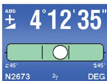
Цифровая индикация и простая ампула (ампульный уровень)
